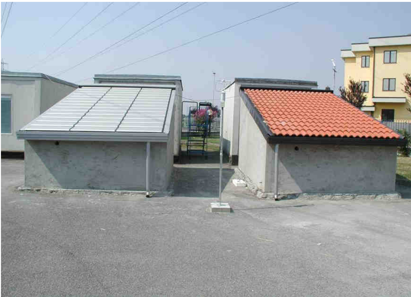
Assetto di prova per test comparativi termofluidodinamici. Progetto di Ricerca ITC-CNR S.Giuliano Milanese + Mazzonetto S.p.A.+ DISET Politecnico di Torino (2005-2007) Responsabili Scientifici: Arch.Vittorio GALIMBERTI (ITC-CNR), Arch.Claudio PELLANDA (Mazzonetto SpA), Prof.Riccardo NELVA (Politecnico di Torino)
