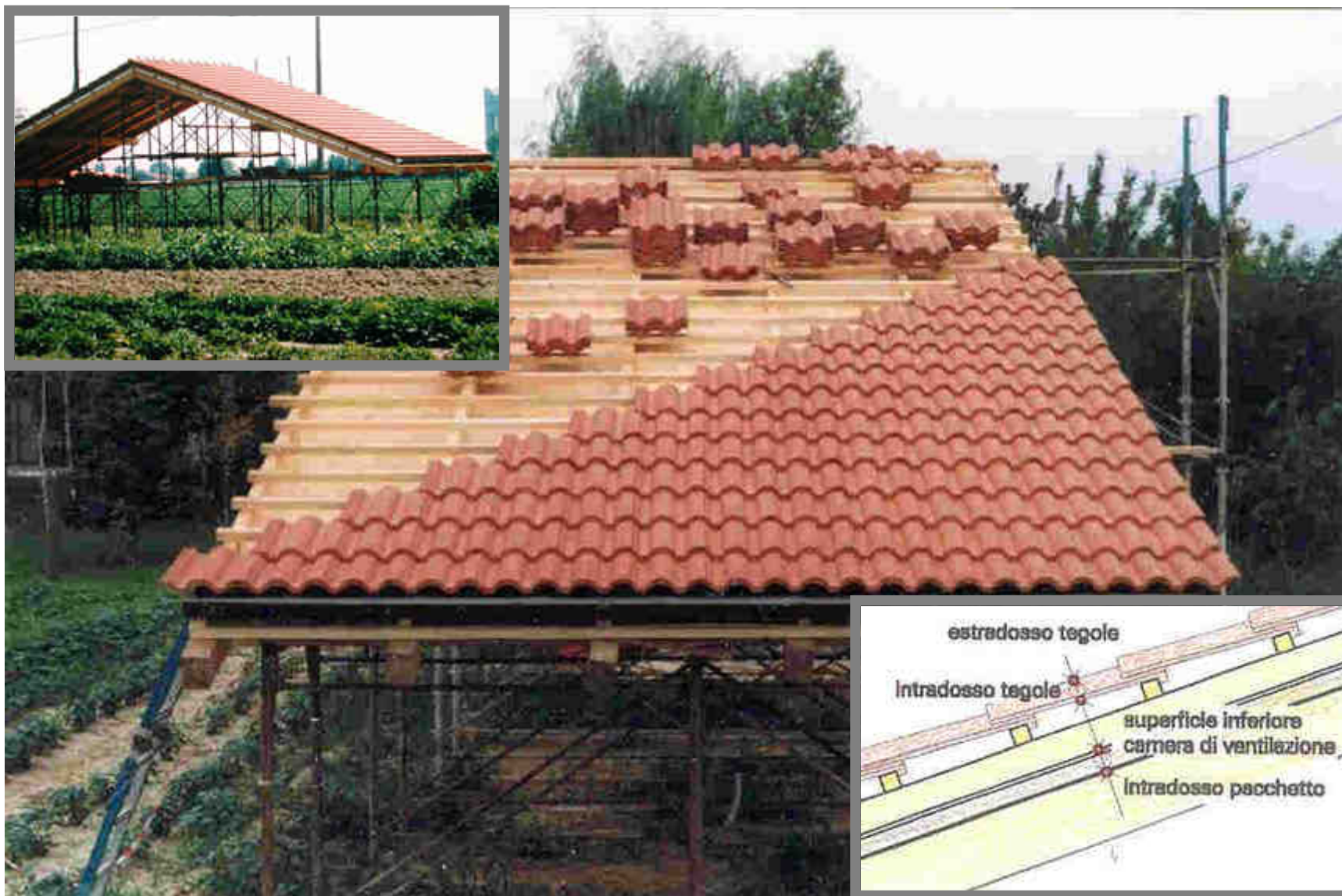
Copertura sperimentale in scala reale in ambiente reale, a due falde ventilate con esposizione nord e sud - Milano - VE Ricerca Sperimentale IUAV 1999 Responsabile Scientifico Giovanni ZANNONI con Fabio PERON, Claudio PELLANDA
