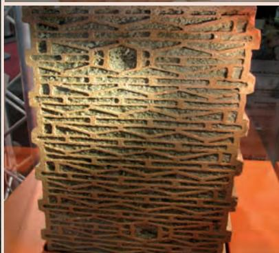
*A sinistra: tolti i letti di malta l'unica via di fuga agevole per il calore in movimento tra le due facce di una muratura è il laterizio stesso. La soluzione di realizzare setti i più sottili possibili ha offerto un miglioramento della prestazione termoisolante, anche se ha diminuito le prestazioni meccaniche costringendo spesso a declassare i prodotti da elementi per muratura portante ad elementi per tamponamento.*
