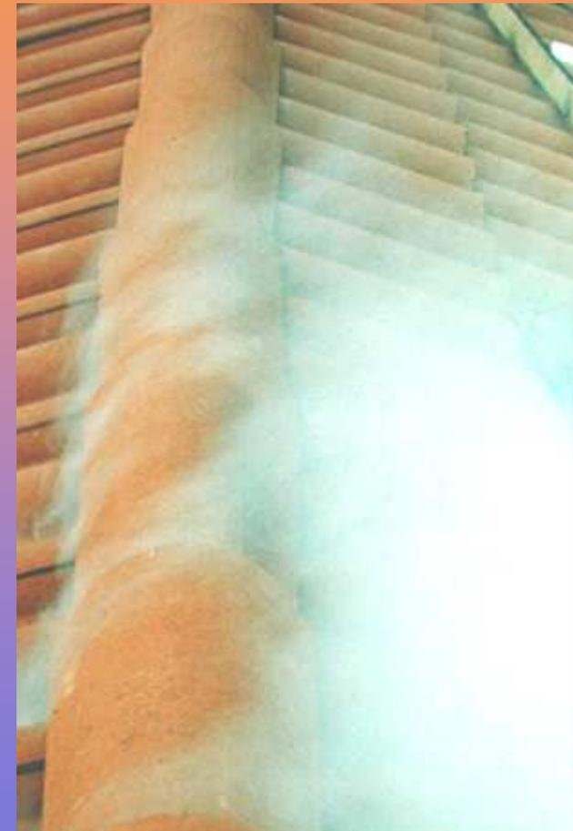
Riprese video sottocolmo di fluido di ventilazione evidenziato con gas tracciante in copertura sperimentale a scala reale
