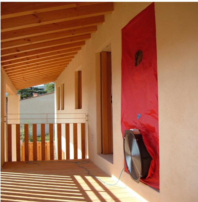
*Per valutare quanto l'involucro di un edificio sia capace di "tenere l'aria" e quindi anche il calore od il fresco (per evitare che vadano dispersi) ed il vapore (il cui percorso verso l'esterno va controllato) è disponibile il Blower Door Test, che si esegue mettendo in depressione ed in sovrappressione l'interno dell'edificio evidenziando con gas traccianti, con anemometri, con fili sospesi od ancora con la termografia, le eventuali infiltrazioni d'aria.*
